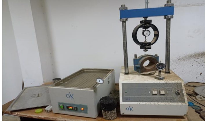
الشكل (10) يوضح جهاز اختبار مارشال
