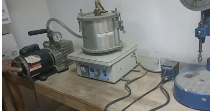
الشكل رقم (9) يوضح جهاز حساب الكثافة القصوى
