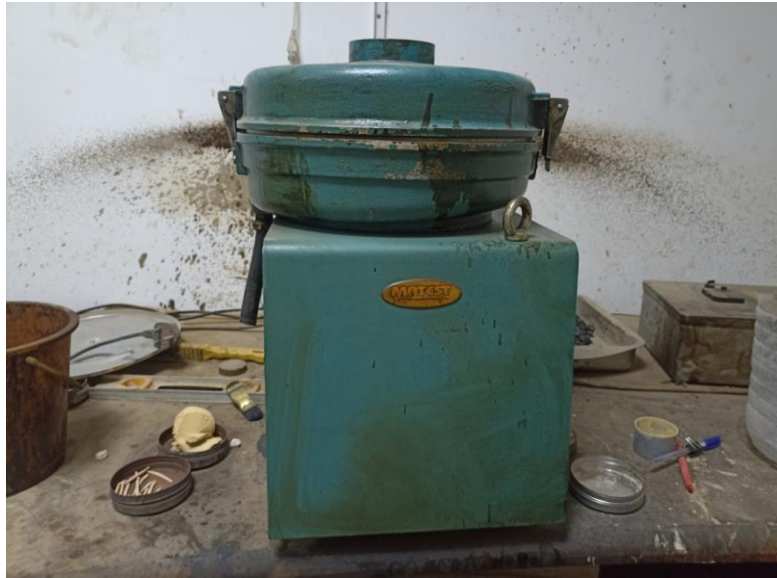
الشكل (11) يوضح جهاز اختبار الاستخلاص
